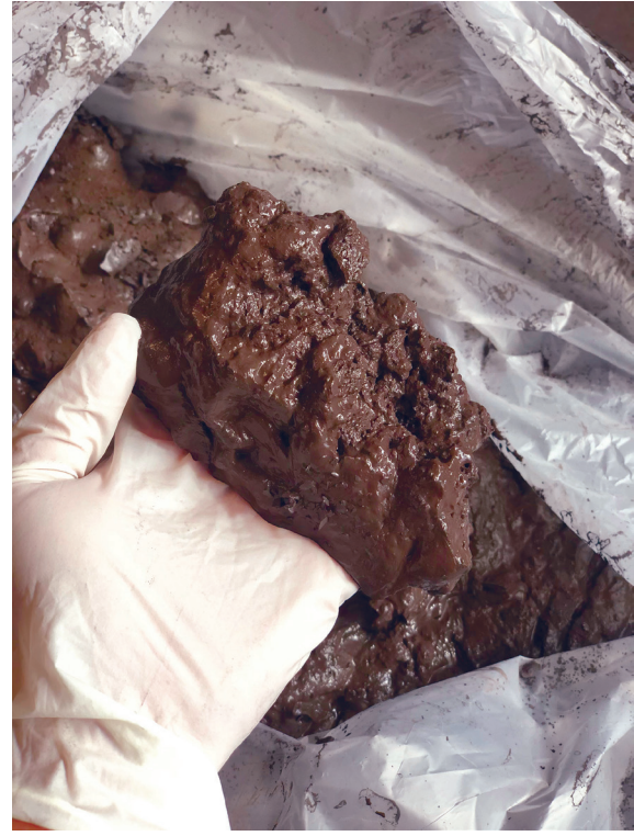
الشكل (12): الحمأة التي تترسب في أثناء معالجة المياه العادمة.
