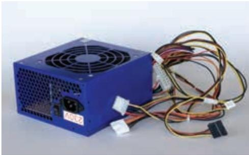
الشكل (١-٤١): وحدة التغذية الكهربائية.
