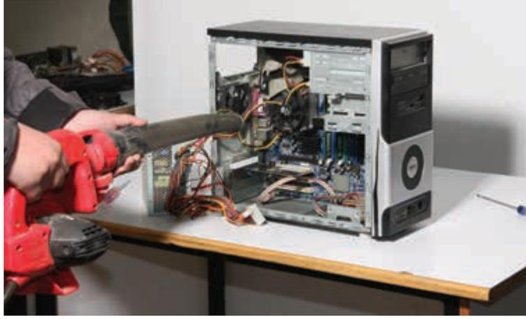
الشكل (١-٥٠): تنظيف جهاز الحاسوب باستخدام الهواء المضغوط.
