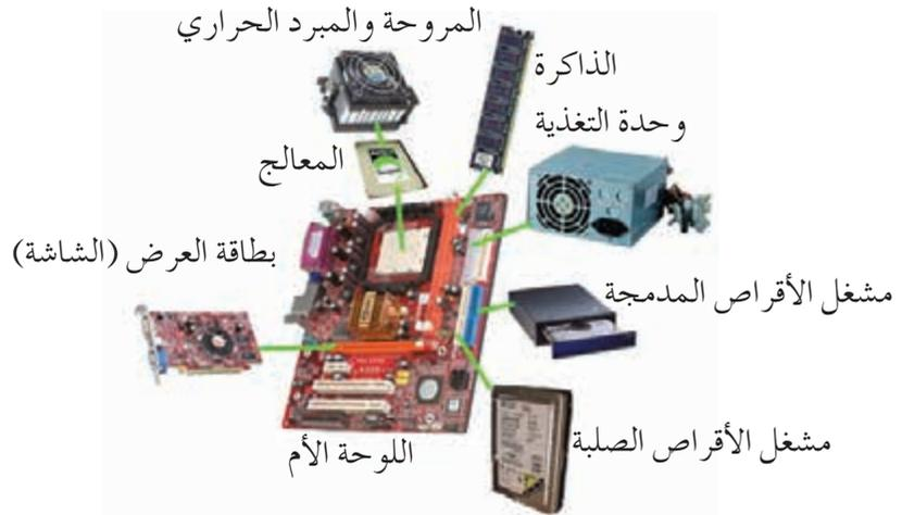
الشكل (١-١): المكونات المادية للحاسوب.
