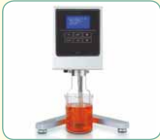
الشكل (٧-١٦): جهاز قياس لزوجة المائع.
