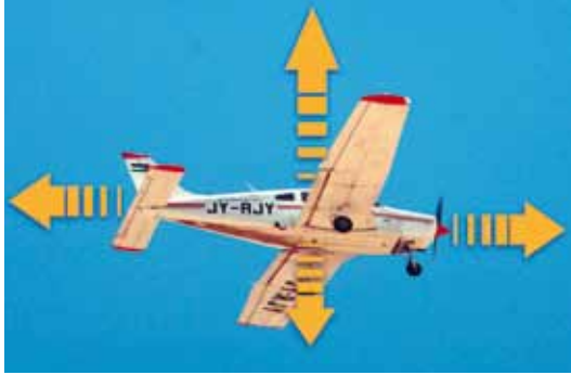
الشكل (٧-١٩): القوى المؤثرة في الطائرة.
