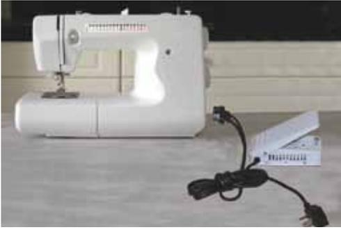
ثم أُدخل تطوّر آخر بإدخال محرك كهربائي تُدار الآلة بوساطته، كما في الشكل (٢-٣)، وهذه الآلة أكثر راحة وسرعة وسهولة في الاستعمال من النوعين السابقين، بالإضافة إلى وجود آلات تعمل على الكمبيوتر.
