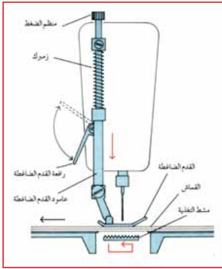
يرتبط منظم ضغط القدم الضاغطة بعمود القدم الضاغطة بوساطة زمبرك، كما في الشكل (٢-٢٨)؛ إذ يزيد الضغط عندما يضغط الزمبرك ويقل عندما يتمدد الزمبرك وتعتمد درجة الضغط على سمك القماش. ويوضح الشكل (٢-٢٩) تأثير قوة ضغط القدم الضاغطة في القماش وشكل الغرزة.
