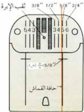
الشكل (٣-٣٣): لوحة المغذي كدليل للدرزة.
