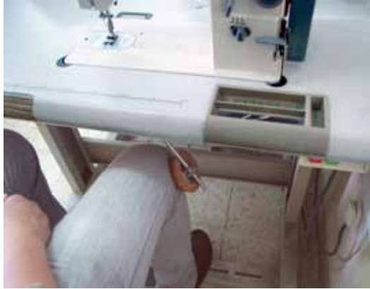
الشكل (٥-٢٥): التحكم بعرض الغرزة بضاغطة الركبة.
