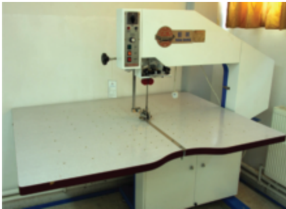
الشكل (٢-٣٢): المقصّ الكهربائي الثابت ذو السكّينة الرأسيّة المتحرّكة المثبتة على منضدة.
