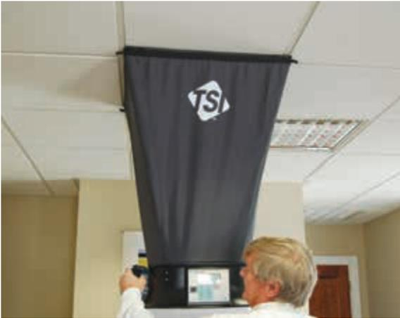
الشكل (٣-٤٤): جهاز لقياس كمية تدفق الهواء.
