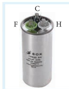
الطرف المشترك ويرمز له بالرمز (C)، ويتم توصيله بخط التغذية الكهربائية وخط ملفات الدوران لكل من محرك الضاغط ومحرك المراوح.
