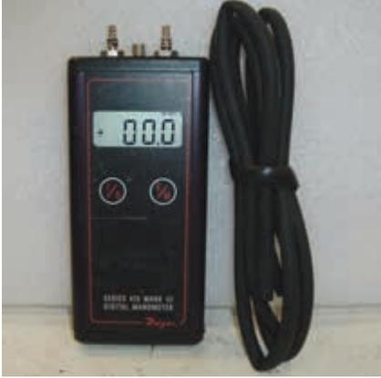
وهو مصمّم لإعطاء دقة في القراءة عند فروق ضغط منخفضة جدًا، وهناك بعض الأنواع التي تعمل عند فروق تتراوح من (٢٥٠ باسكال إلى ١٥٠٠٠ باسكال)، وهو يعمل بطريقة عمل المانوميتر التقليدي إلا أن القراءة تظهر مباشرة بصورة رقمية على شاشة الجهاز، وهناك بعض الأجهزة التي يتمّ تزويد بها؛ لتقوم بوظائف أخرى كقياس درجة الحرارة، ويبيّن الشكل (٣-٣٤) نوعًا من هذه الأجهزة.
