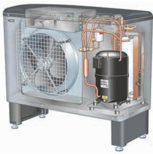
تتكوّن الوحدة الخارجية، كما في الشكل (٤٩-٢)، من ضاغط، ومكثف، والمروحة الخاصة به، وصمام تمدد، وصمامات الخدمة، والدارة الكهربائية الخاصة بهذه المكونات، وتحتوي المضخات الحرارية على صمام عاكس وصمام عدم رجوع. والشكل (٥٠-٢) يظهر وحدة خارجية مفككة، ويبيّن أجزاءها.
