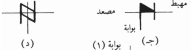
إن إمكانية التحكم بمرور التيار في المقومات المحكومة في حالتها الانحياز الأمامي والعكسي قد أوجدت تطبيقات كثيرة مثل التحكم في سرعات الآلات الكهربائية، وغيرها. وتصنع هذه المقومات في الغالب من عدة طبقات (Layers) من مواد شبه موصلة أشهرها السيليكون.
