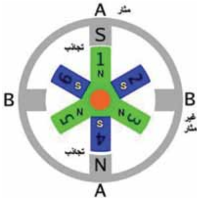
الشكل (٣-٢٣): محرّك الخطوة ذو المغناطيس الدائم.
