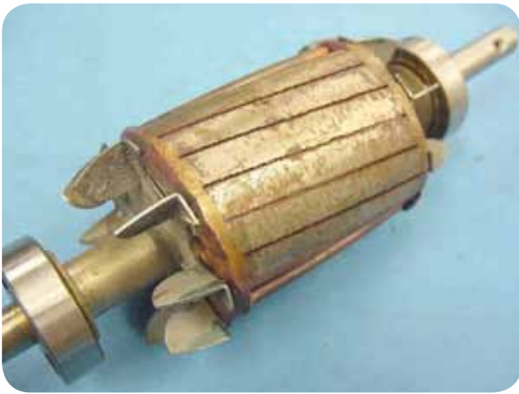
الشكل (٢ - ٥): العضو الدوّار من نوع القفص السنجابي.
