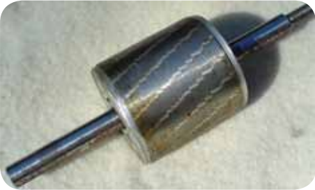
الشكل ( ١ - ٦ ) : العضو الدوّار ذو القفص السنجابي .
