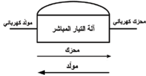
الشكل (٣ - ١): عمل آلة التيار المباشر.
