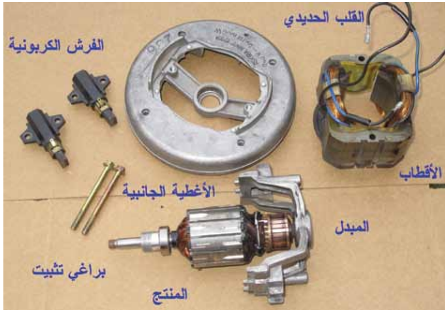
الشكل (٣-٤١): صورة تبين أجزاء المحرك العام.
