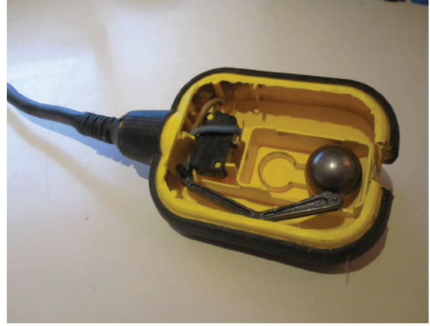
(أ) مكونات طافية التحكم في مستوى السوائل.
