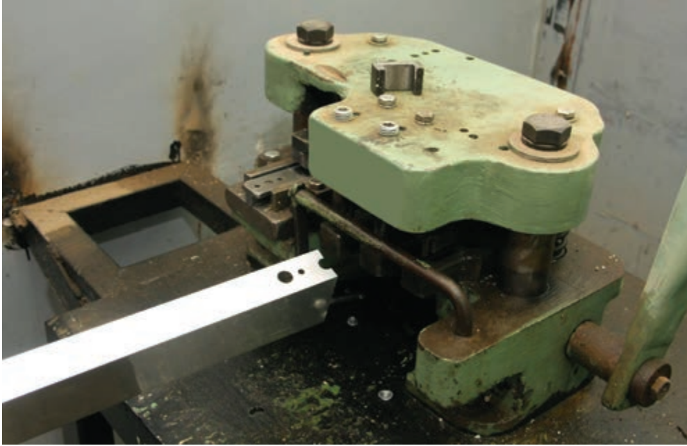
الشكل (١-٥٧): عملية فصم السكين والزرّفيل لتثبيت أرضية الدرّفة.
