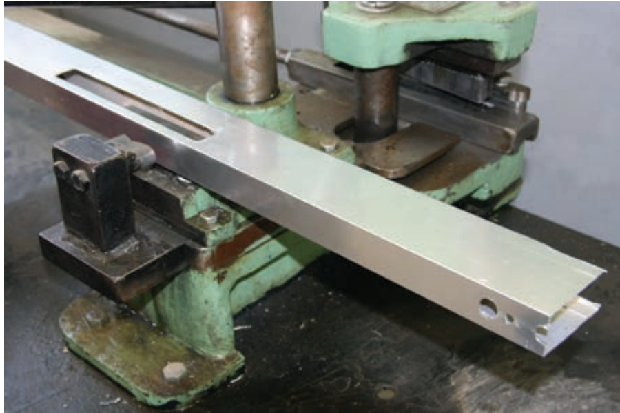
الشكل (٦٤-١): مكبس فصم فتحة لاقط الزر فيل.
