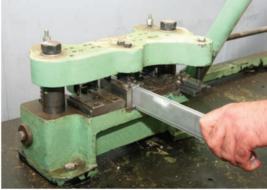
الشكل (٤٩-١): وضع مقطع ألنيوم منخل منع الحشرات على المكبس.
