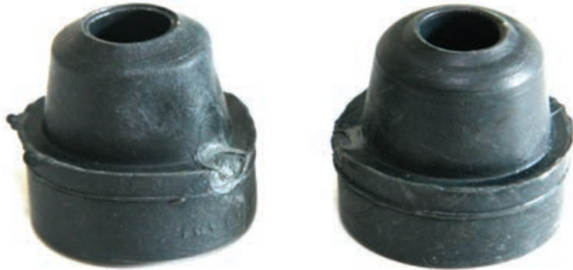
الشكل (٢-١٠): ماصّات الصدمة الكبيرة (المصدات).
