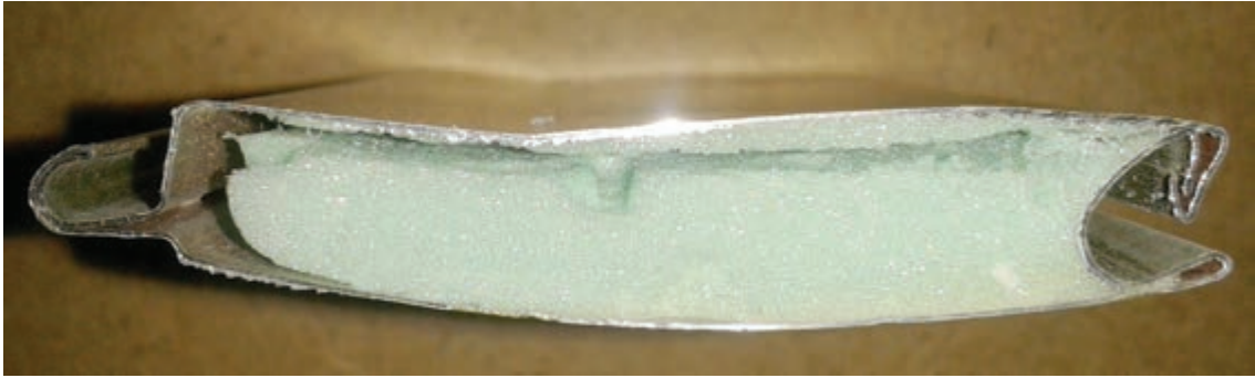
الشكل (٤١-١): مقطع الأباجور بعد عزله.
