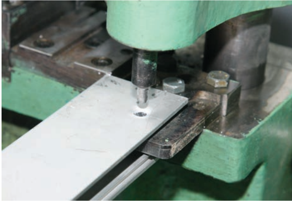
الشكل (٥٩-١): مكبس أرضية الدرفة التي يركب عجل السحاب ويُثبَّت على مقطعها.
