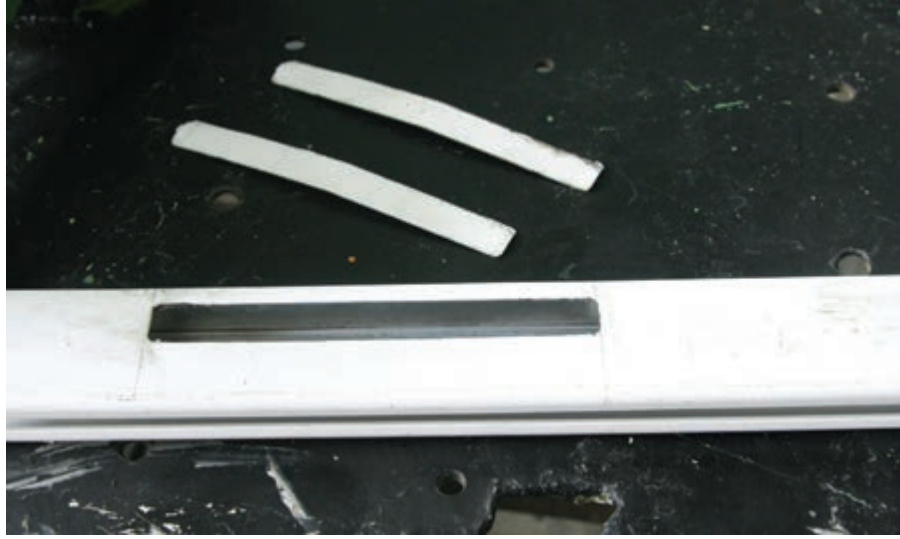
الشكل (٦٣-١): فتحة الزر فيل بعد فصمها.
