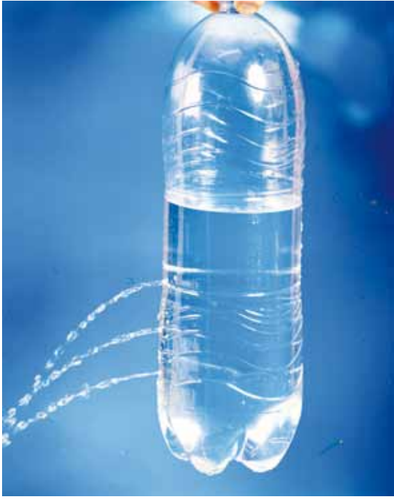
الشكلُ (٣-١٦): العلاقةُ بينَ ارتفاعِ الماءِ وضغطِهِ.
