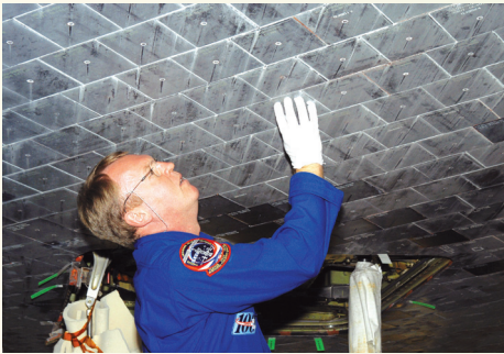
الشكل (٦-١٧): تفقد القطع العازلة بعد الرحلة.
