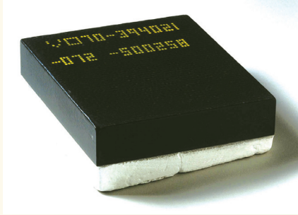
الشكل (٦-١٦): تغليف مقدمة المكوك بالقطع العازلة.
